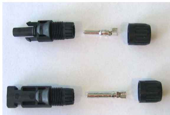
Figure 6.6 : Assemblage des connecteurs MC
